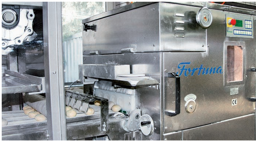
Die Kopfmachine Fortuna KM wirkt auch Teiglinge aus weichen Teigen genau und zuverlässig. Fotos: Pöttsch
