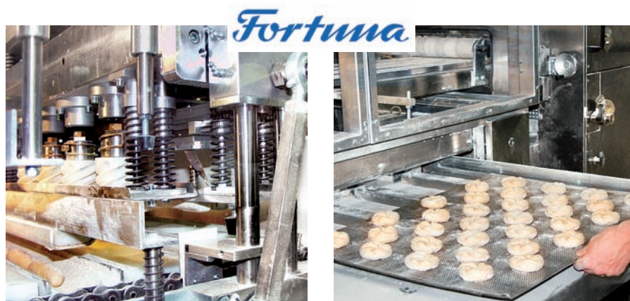
Hinter der Stüpfelstation (links) sitzt die Schneidestation, die in die Teiglinge einen Schnitt macht wie von Hand. Abgesetzt wird auf Bleche oder Sturzkästen.
